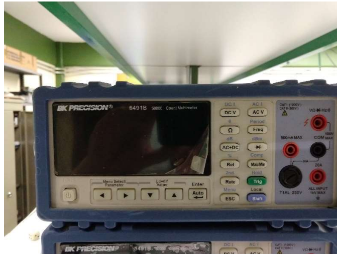
Ilustración 6. Multímetro utilizado para medir Corriente y Voltaje
