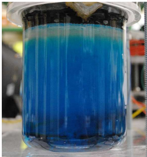
Ilustración 16. Azul de metileno y agua destilada después de 10 min presenta un cambio de turbidez.
